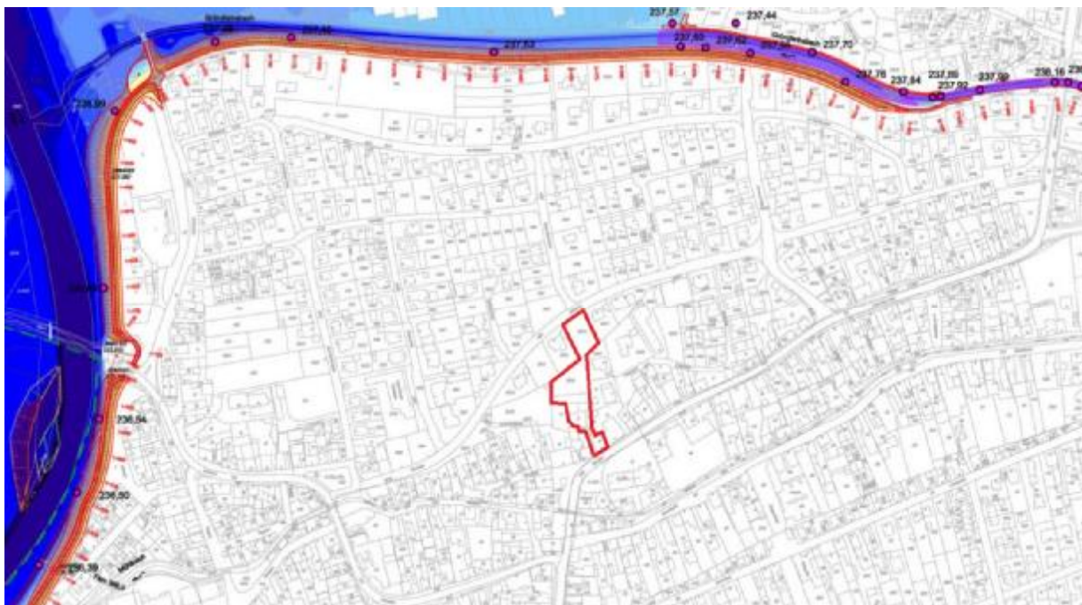
Abb. 4: Hochwasserschutz Hallstadt-Dörfleins – Deichnachrüstung – Planungszustand (B-Plangebiet in rot, Quelle: Dr. Blasy – Dr. Øverland – Beratende Ingenieure GmbH & Co. KG)
